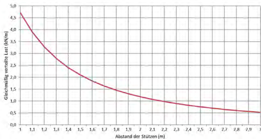
Zulässige Belastung KP 60/400 d=1,0mm (kN/m)
