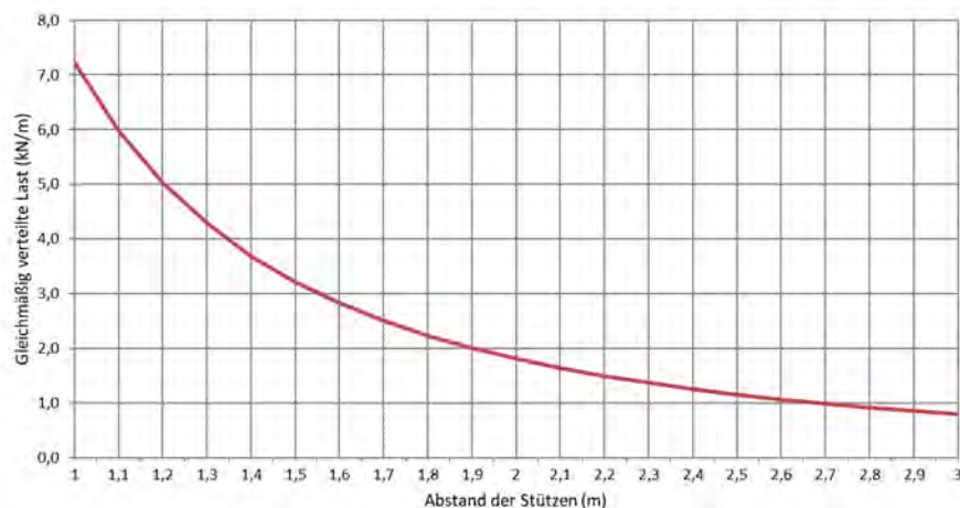
Zulässige Belastung KL 100/600 d=1,0mm (kN/m)
