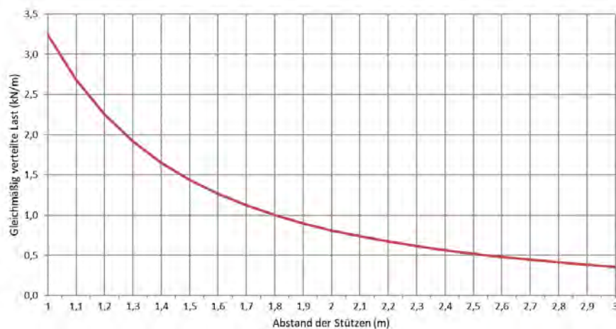
Zulässige Belastung KP 60/600 d=0,8mm (kN/m)
