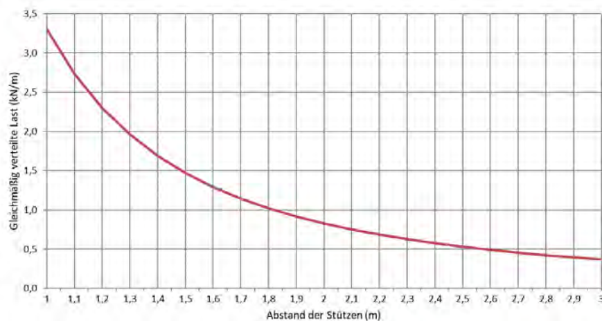
Zulässige Belastung KP 60/500 d=0,8mm (kN/m)
