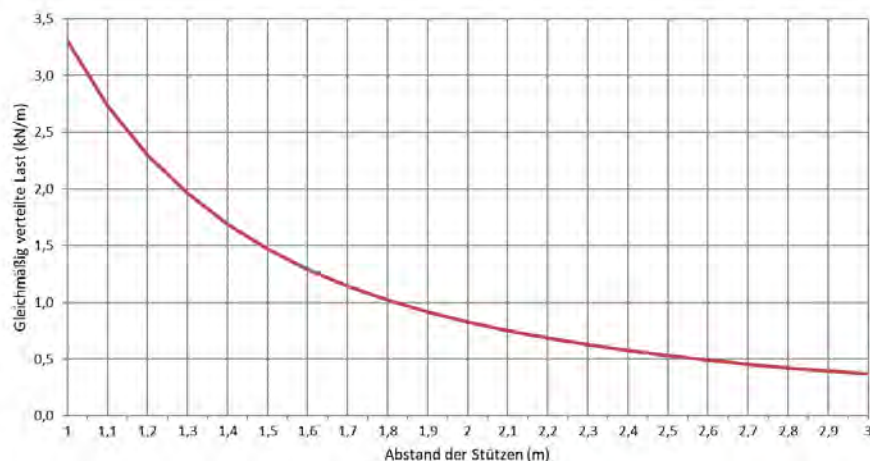
Zulässige Belastung KP 60/500 d=0,8mm (kN/m)
